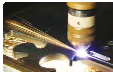
Mechanisiertes Plasmaschneiden Mechanised plasma cutting
