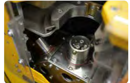
Bestückung mit bis zu acht Brennerköpfen Equipping with up to eight torch heads
