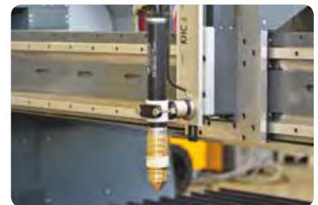
Präzise Abstandsregelung | Precise height control
