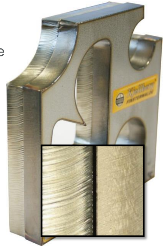
Vergleich Unterwasser- und Trockenschnitt 10 mm Edelstahl
