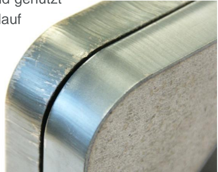
Vergleich Unterwasser- und Trockenschnitt 15 mm Baustahl
